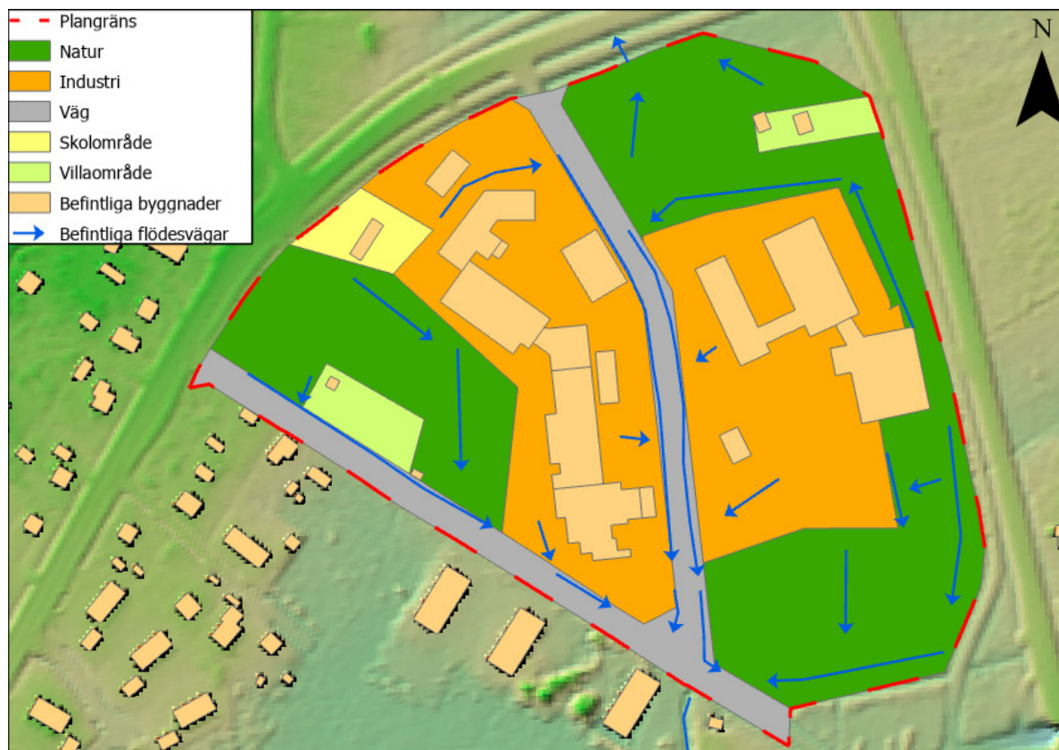
Figur 7. Dagens markanvändning och befintliga rinnvägar inom planområdet.
