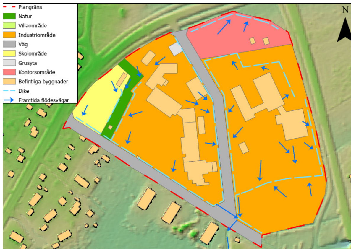
Figur 8. Planerad markanvändning och rinnvägar.
