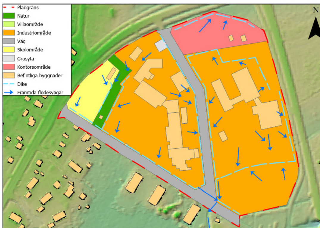
Bild 15. Utdrag ur dagvattenutredningen. De blåa pilarna visar dagvattnets flödesvägar.
