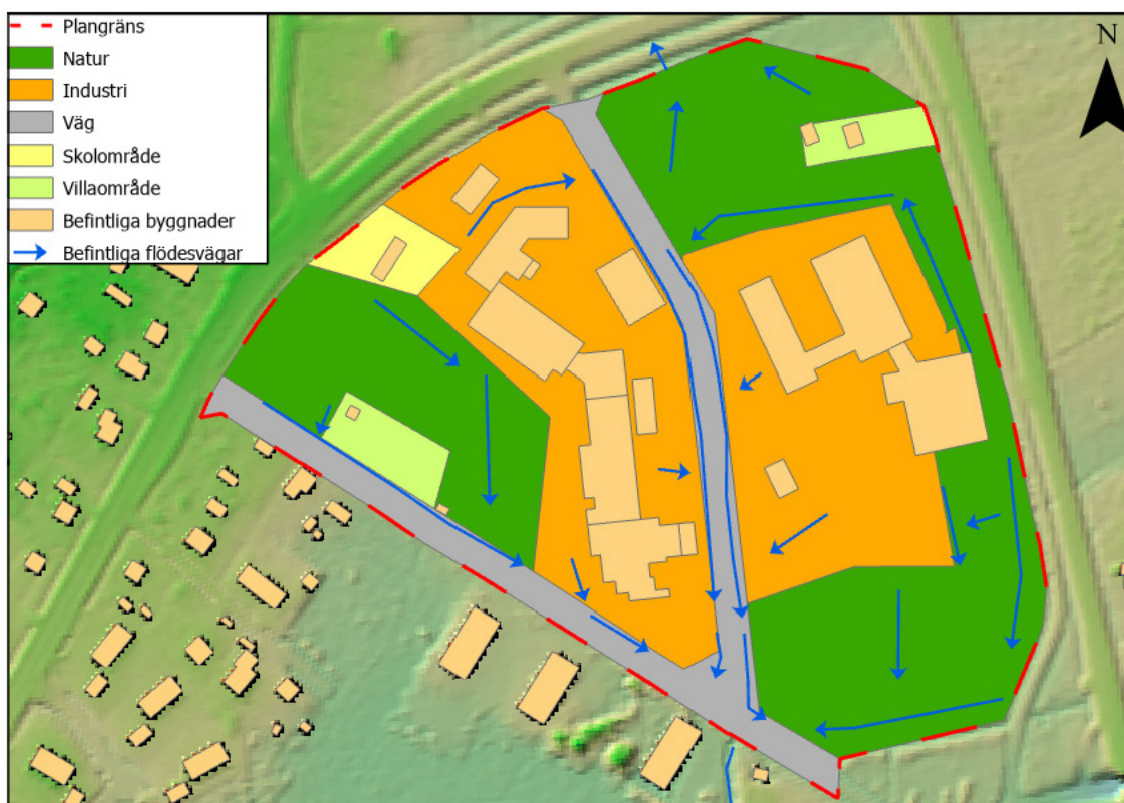
Bild 7. Utdrag ur dagvattenutredning. Bilden visar nuläget inom planområdet.
